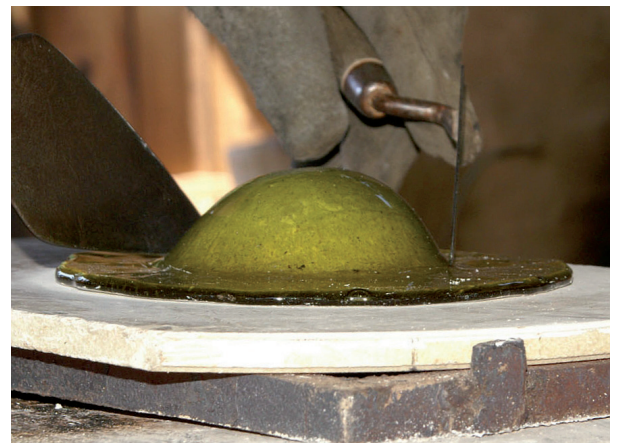
Abb. 10: Formkorrekturen im Übergang zwischen dem geraden Rand und der Kuppel (Foto: M. Arz).
