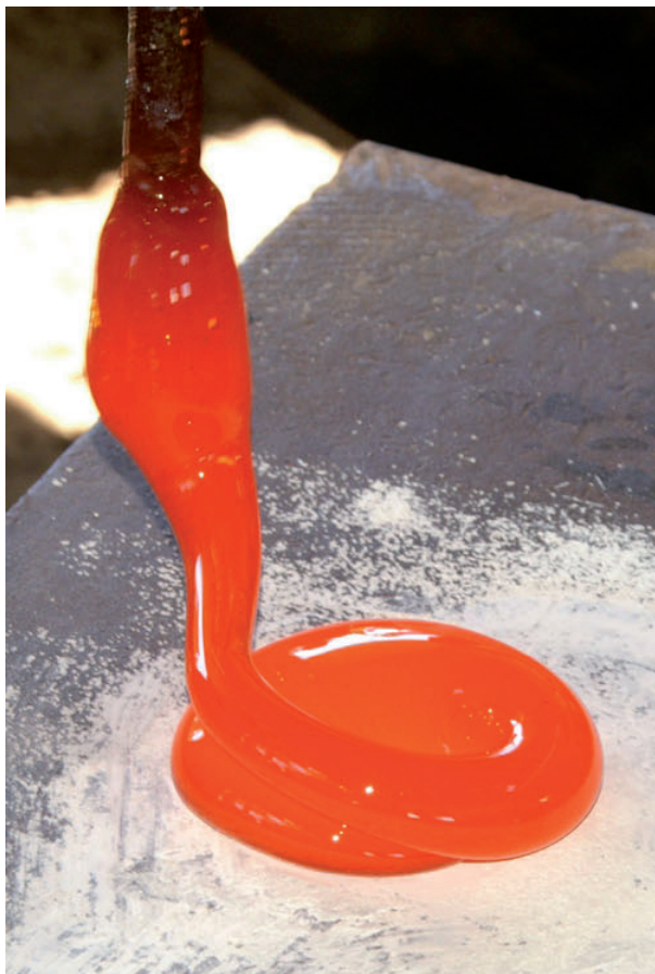
Abb. 1: Ablaufen der zähflüssigen Glasmasse auf eine mit Trennmittel bestreute Unterlage (Foto: M. Arz).
