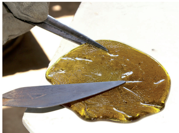
Abb. 2: Abflachen des Glaspostens zu einem Fladen (Foto: M. Arz).
