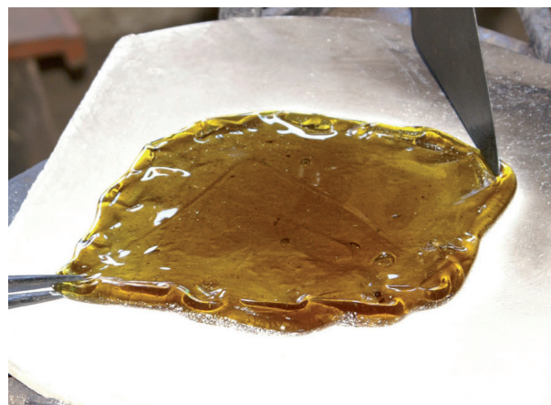
Abb. 3: Strecken des Glasfladens (Foto: M. Arz).
