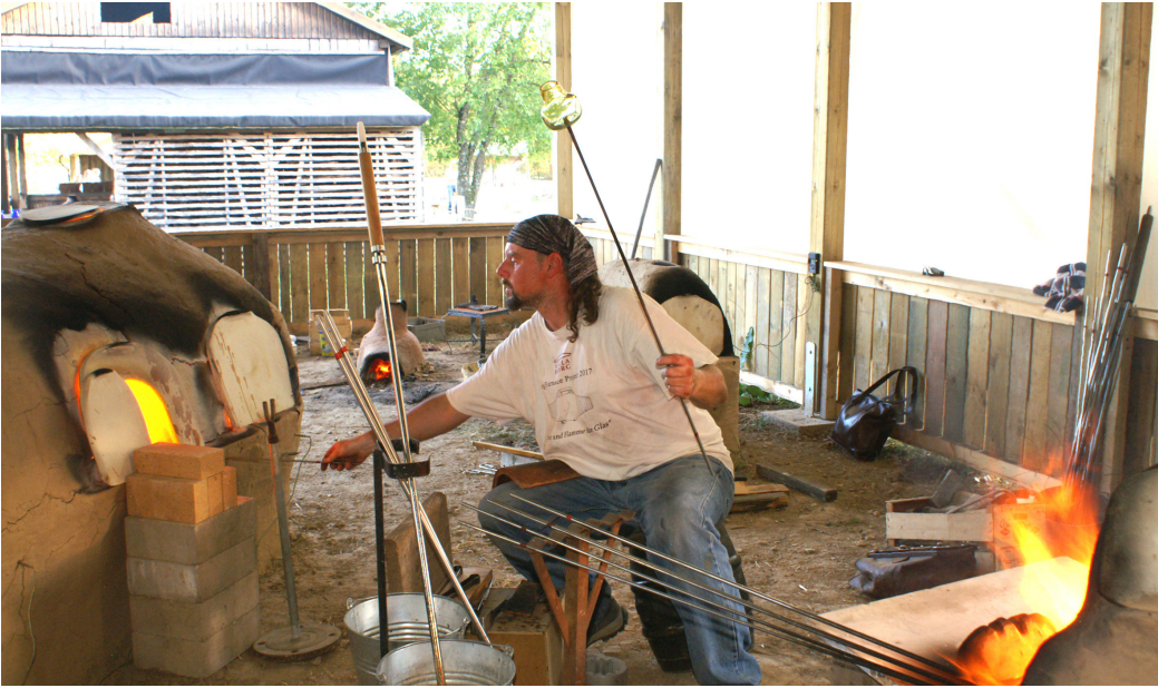
Abb. 6: Aufnahmen von heißem Glas im Wannenofen beim Arbeiten am Hafenofen GO-Borg-4 (rechts). – Gathering glass from the tank furnace while working at the pot furnace GO-Borg-4 (right).
