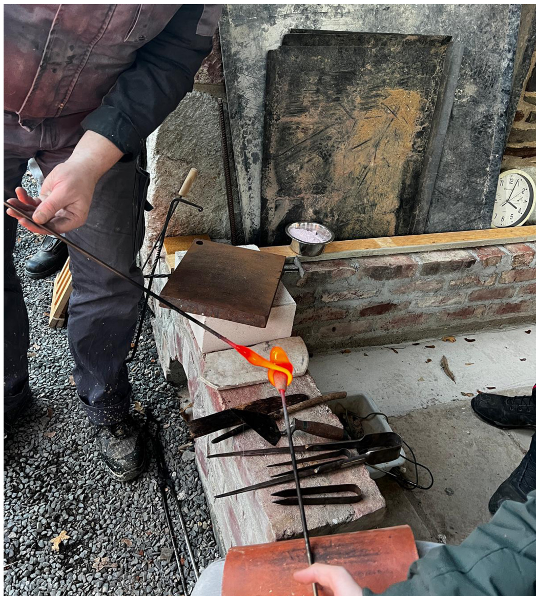
Abb. 7: Aufwickeln eines heißen Glaspostens auf den Lehmkern. – Winding a parison of hot glass onto a daub core.
