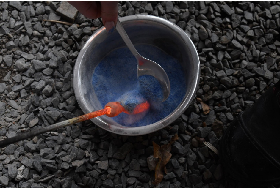
Abb. 9: Auflöffeln von Glaspulver auf den Lehmkern. – Spooning on powdered glass onto the daub core.
