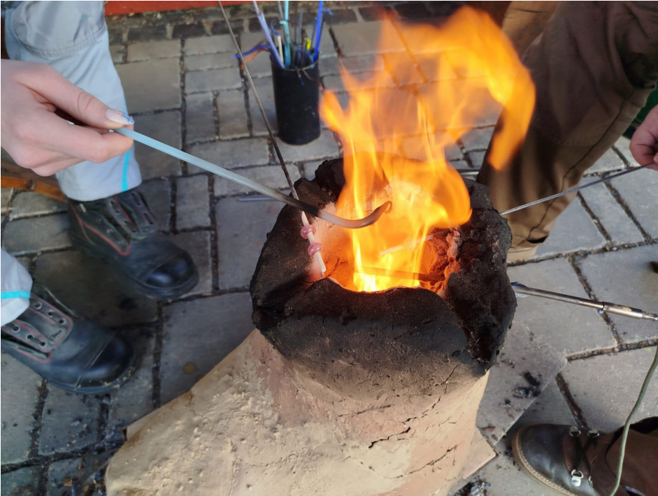
Abb. 8: Herstellung von Wickelglasperlen mit Glasstab und Perlendorn. – Glass beadmaking using a glass rod and a steel mandrel.
