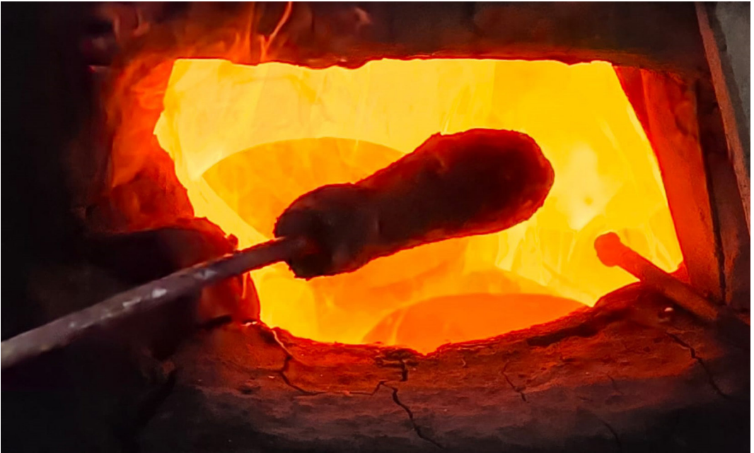
Abb. 6: Eintauchen des Lehmkerns in die Glasmasse. – Dipping the daub core into the molten glass.
