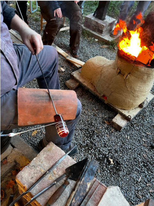
Abb. 10: Aufwickeln eines Zierfadens. – Trailing on a thread decoration.
