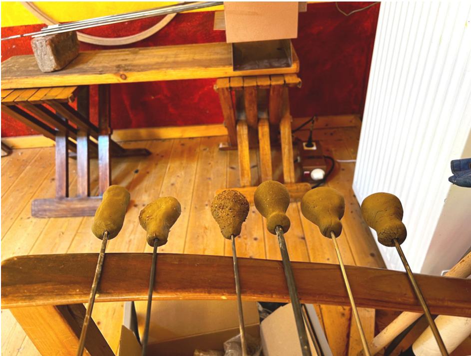
Abb. 4: Trocknen der Lehmkerne. – Drying the daub cores.
