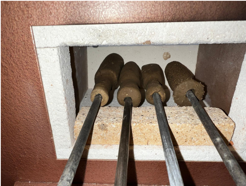
Abb. 5: Trocknen der Lehmkerne in einem kleinen elektrischen Ofen. – Drying the daub cores in a small electric kiln.
