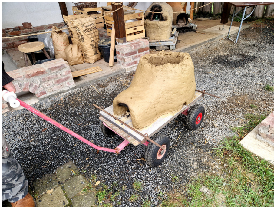
Abb. 1: Bau des neuen Glasofens auf einem Bollerwagen. – Building the new glass furnace on top of a handcart.
