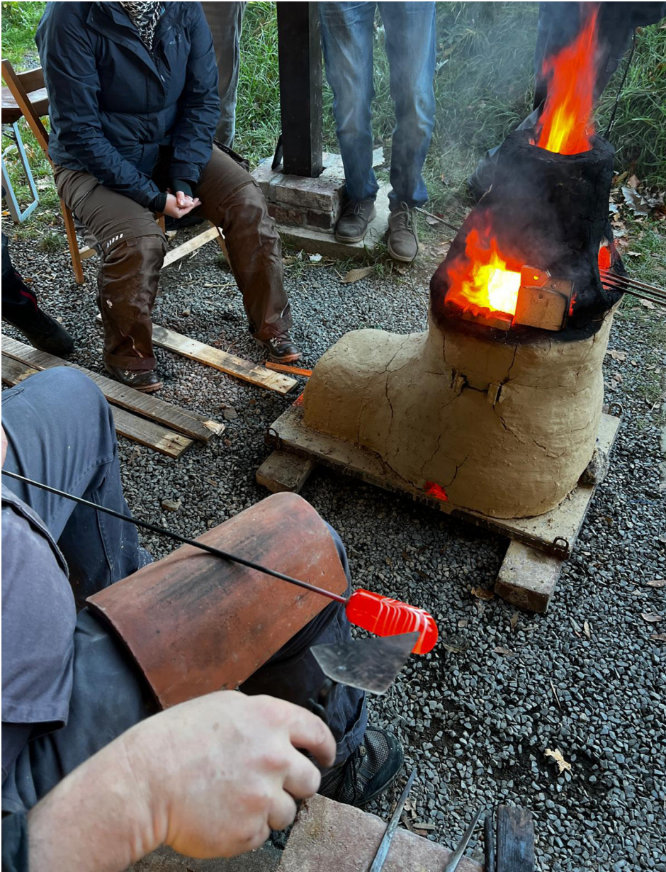
Abb. 11: Verziehen des Fadendekors zum Vogelfedermuster. – Pulling the thread decoration into a feather pattern.
