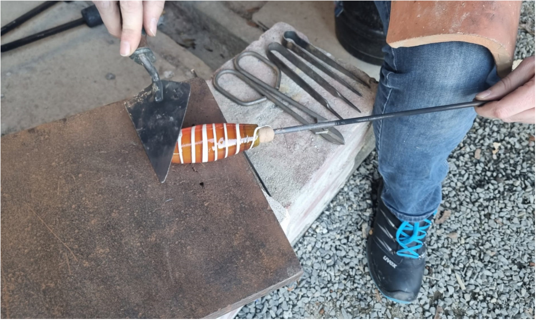
Abb. 12: Formen und Umverteilen des heißen Glases mit der Maurerkelle. – Forming and adjusting the distribution of the glass using a mason's trowel.
